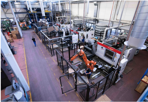
Die hoch automatisierte Fertigung mit modernsten 5-Achs-Bearbeitungszentren befindet sich bei Bucher Hydraulics im Haus.
